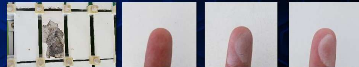
耐白亜化試験 煌4Fシリーズ A社フッ素塗料 B社フッ素塗料
